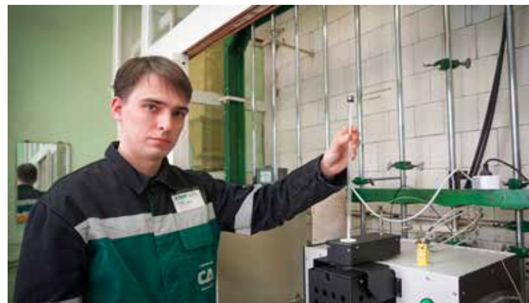
▲ Алексей Дмитриев проводит испытание катализатора на проточной каталитической установке
