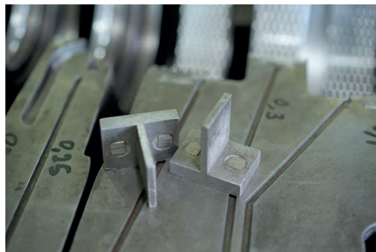
▲ Одно из первых рационализаторских предложений Виталия Полякова — закладные калиброванные пластины на магнитной основе для перекатовки и транспортировки внутренних «пучков» ЦНД, ЦСД и ЦВД поз. 401 для цехов аммиак-1 и аммиак-2. Позволяют заполнить зазор между диафрагмами и предотвратить излом, повреждение стяжных шпилек — простое и эффективное решение
