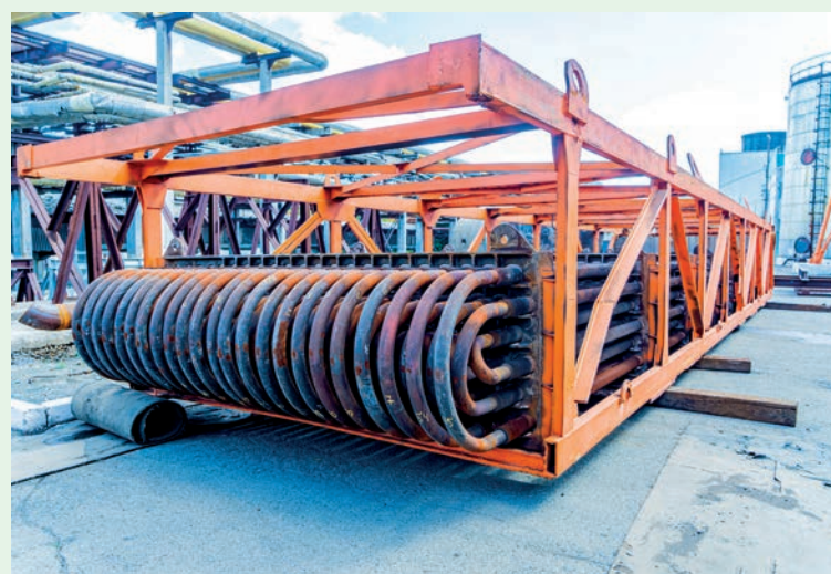
▲ Верхняя часть пароперегревателя на площадке цеха аммиака-2
