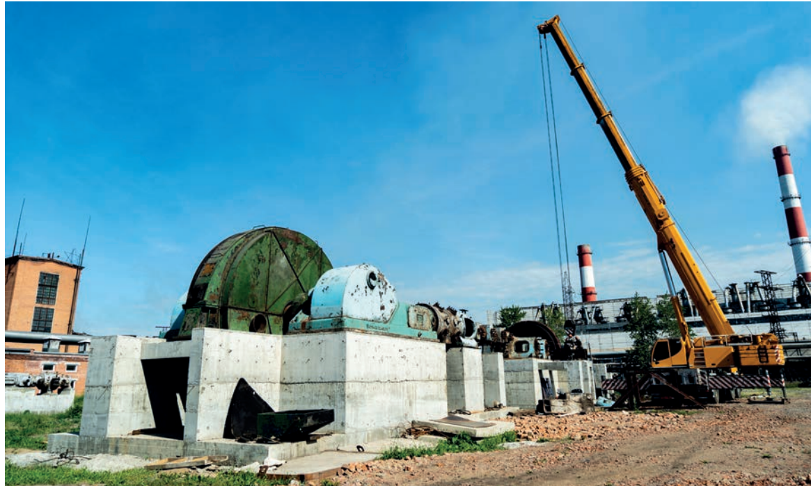
▲ Давление поршневых компрессоров Schwarzkopf и Borsig изначально было 320 кг, но в связи с проведёнными реконструкциями производства водорода максимальное давление было снижено до 240 кг
