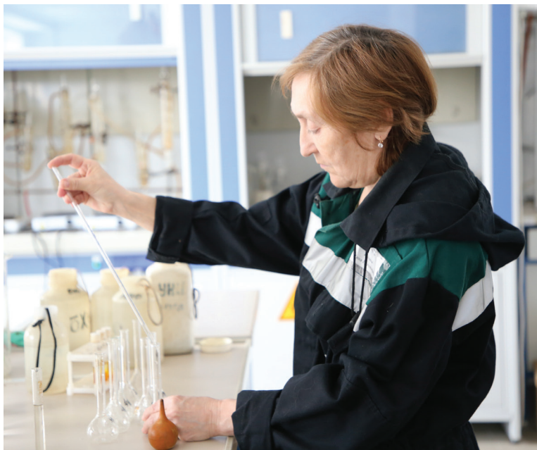
▲ Лаборант химического анализа 5 разряда Санитарной лаборатории Нина Бахтина проводит анализ промливневых сточных вод на содержание азота аммонийного
