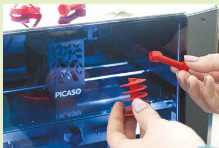
Вот такие детали из полиамида-6 можно распечатать на 3D-принтере
