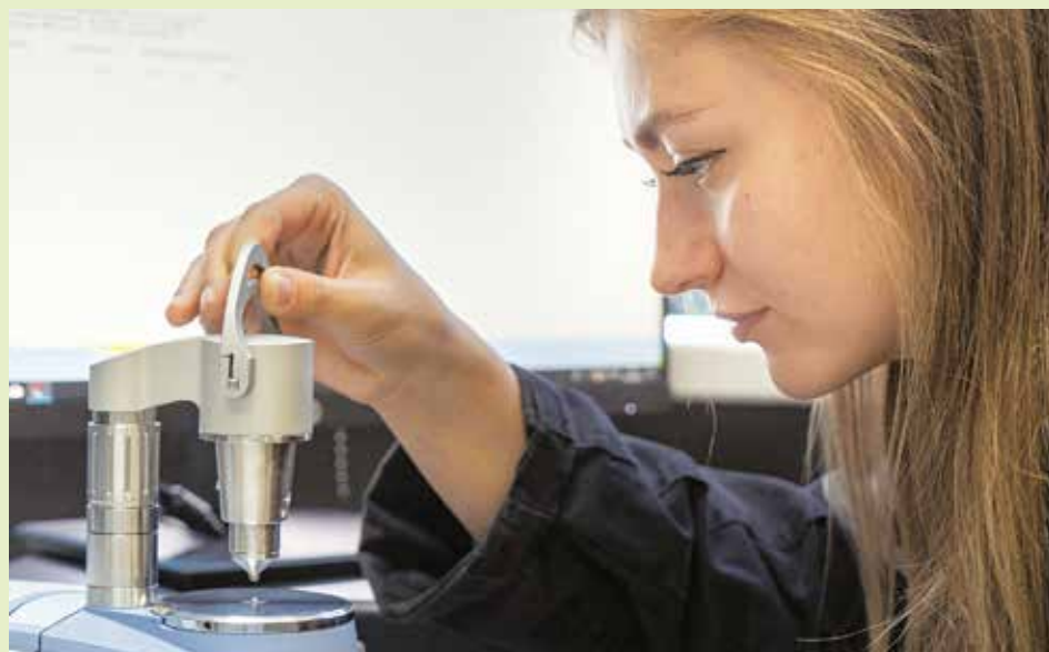
Достаточно положить образец на алмазную призму, прижать специальным прессом и в течение минуты вы сможете узнать все о новой партии продукта
