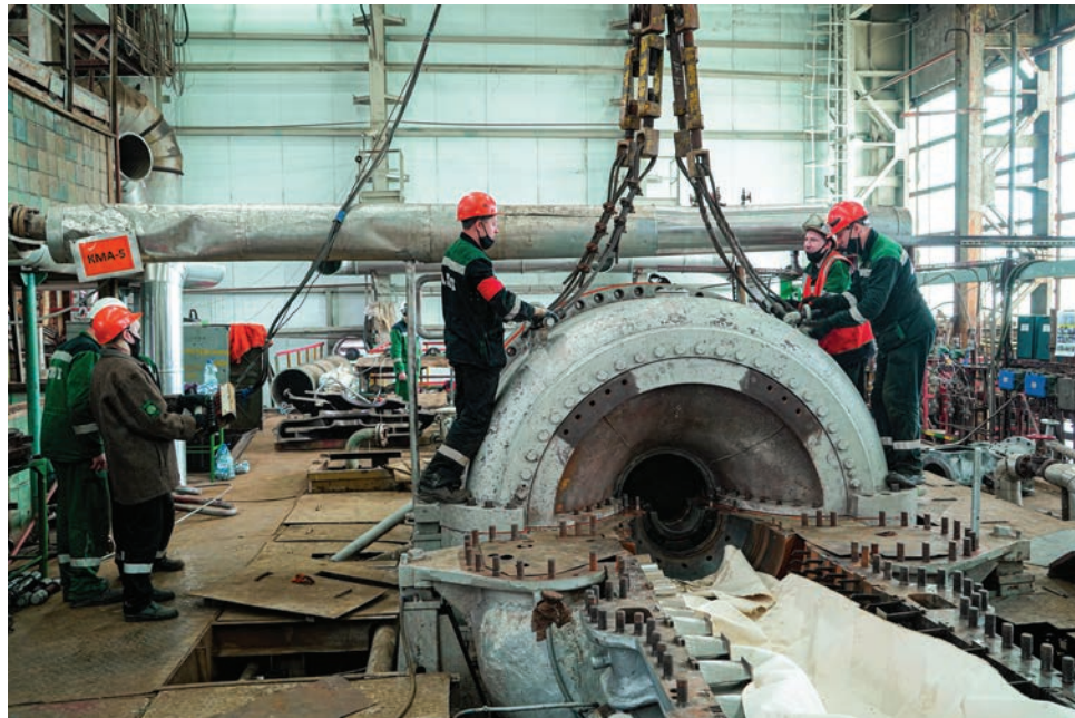
▲ Сборка корпусных деталей турбины низкого давления КМА-5 для проверки плоскости разъемов в цехе № 15
